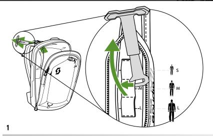
OPEN THE BACKPACK. INSERT THE TRIGGER IN THE SHOULDER STRAP, TURN UP THE HANDLE TO CHANGE THE HEIGHT POSITION AND CLIP IT ON THE SHOULDER STRAP WEBBING.
