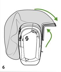
PUSH THE AIRBAG TOWARDS THE LEFT AND PUSH THE UPPER PART TOWARDS THE RIGHT. LEFT HAS TO OVERLAY THE RIGHT PART.
